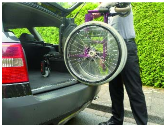
Der Rolliroller liegt auf der Ladekante auf. Der Rollstuhl kann jetzt mit äußerst geringem Kraftaufwand in den Kofferraum "gerollt" werden. Es funktioniert verblüffend einfach.
